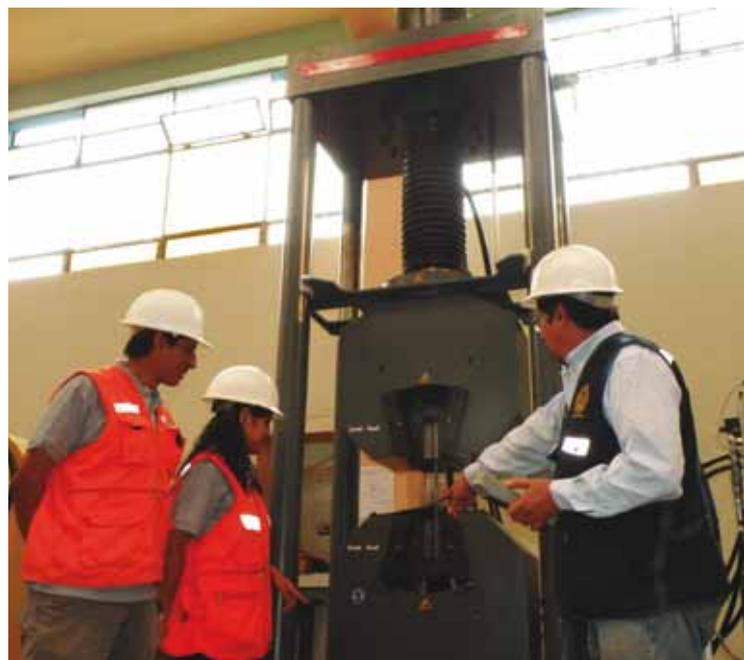
*Prensa de 300 toneladas para ensayos de materiales.*
